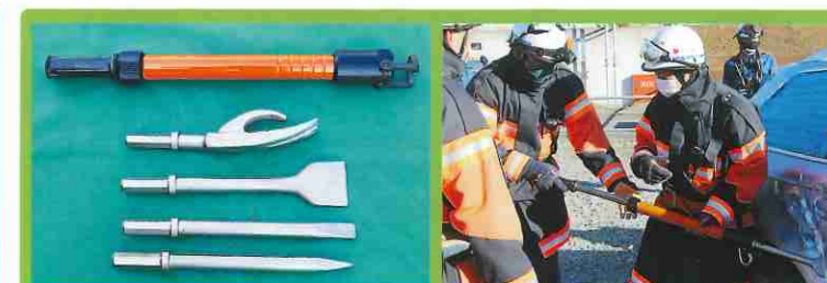
ストライカー（携帯用コンクリート破壊器具）
